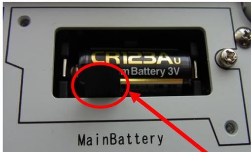
テープを上を引くと電池が外れます。交換の際は故障の原因になりますので、電池の極性にご注意ください。
