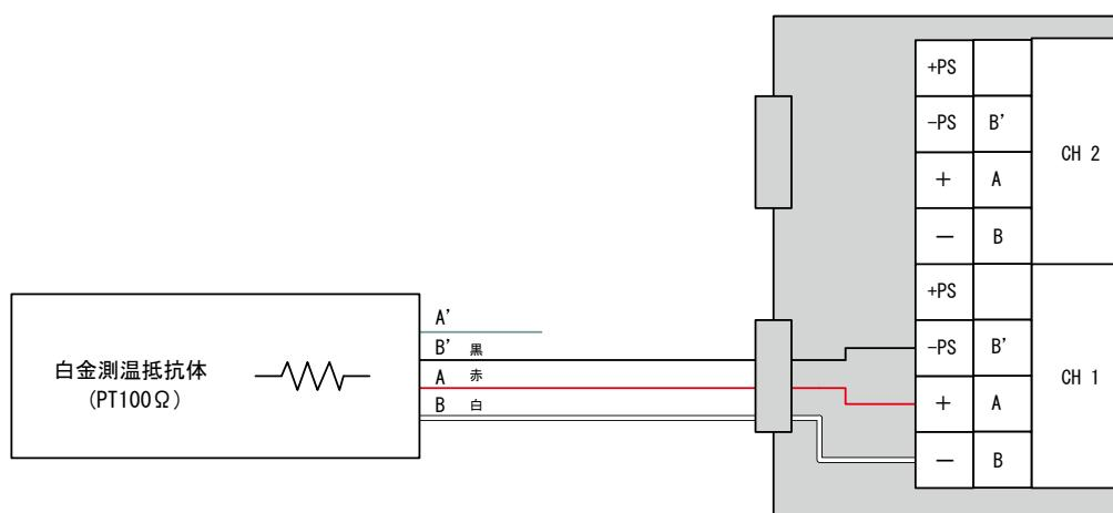
図の信号線の色は、ノースワン製 KDC-S03 の白金測温抵抗体の各信号線の線色です。
