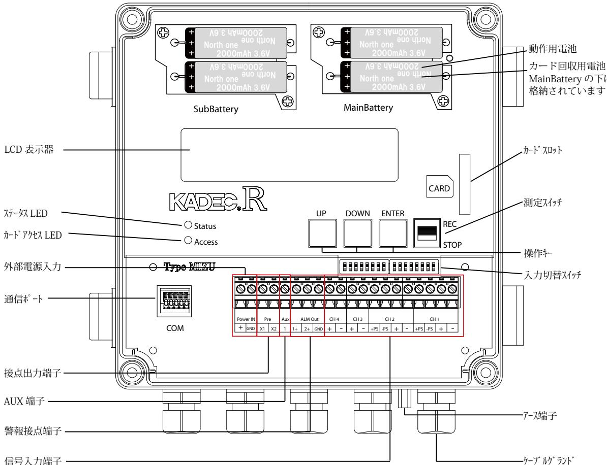
**動作用電池**：測定用動作電池です。専用リチウム電池パック (NRH-B06) または CR123A 用電池ホルダー (KDC-B01-U21) を付属のネジで接続します。
