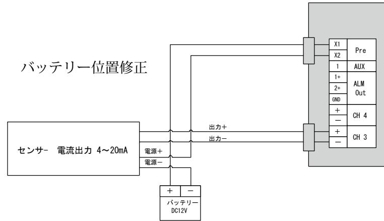
2線式の電流出力センサーの場合。
