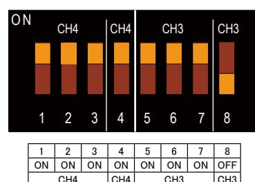
KADEC-R-MIZU の内部では、CH3 と CH4 の入力回路はそれぞれ独立しています、CH3 に電圧出力のセンサー、CH4 に電流出力のセンサーなど、別種類のセンサーを混在して使用する事も可能です。
